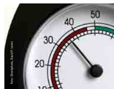
Ein Hygrometer misst die Luftfeuchtigkeit.
